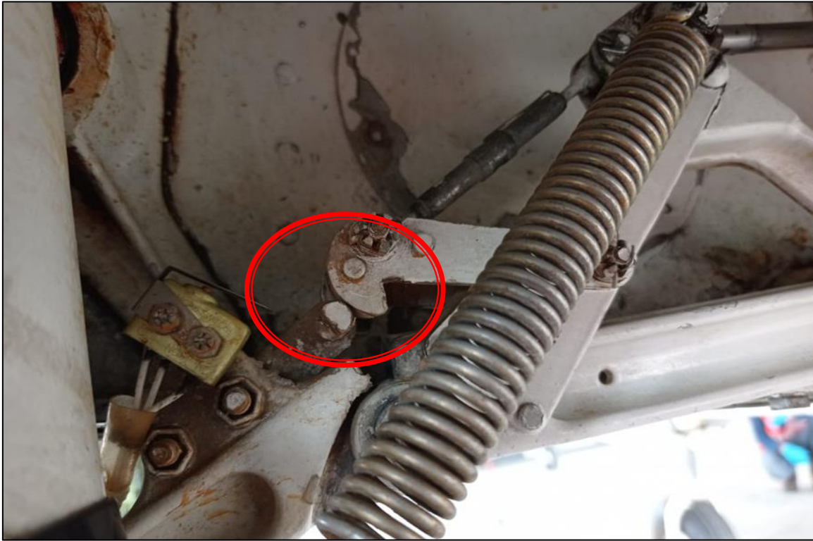
Fotografía No. 3: Mecanismo de seguro del tren izquierdo
